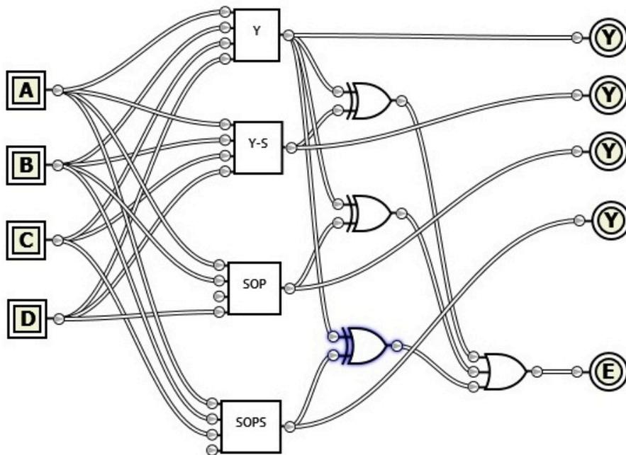
**Esercizio 3:** Ricavare la forma tabellare, la prima forma canonica e la forma algebrica del seguente circuito semplificando dove possibile.
